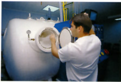
Figura 13. La cámara dispone de un sistema de esclusas para facilitar el intercambio de equipamiento y/o medicación.
