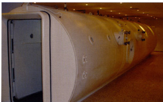
Figura 1. Cámara hiperbárica multiplaza con capacidad para tratamiento de 20 enfermos a la vez.
