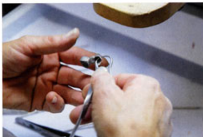
Figura 16. Repasado del metal (Sistema convencional).
