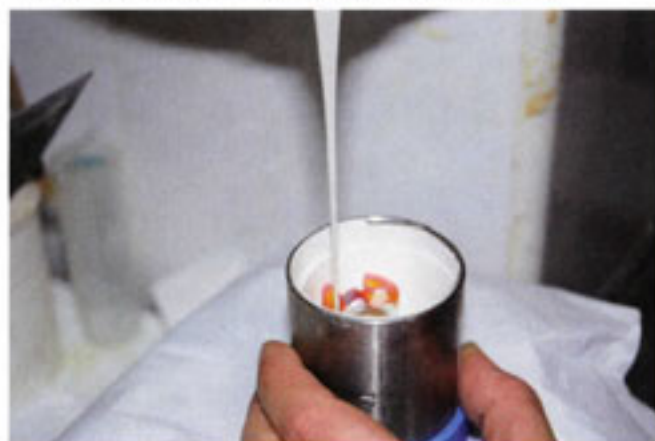
Figura 11. Colocación del revestimiento en el cilindro.
